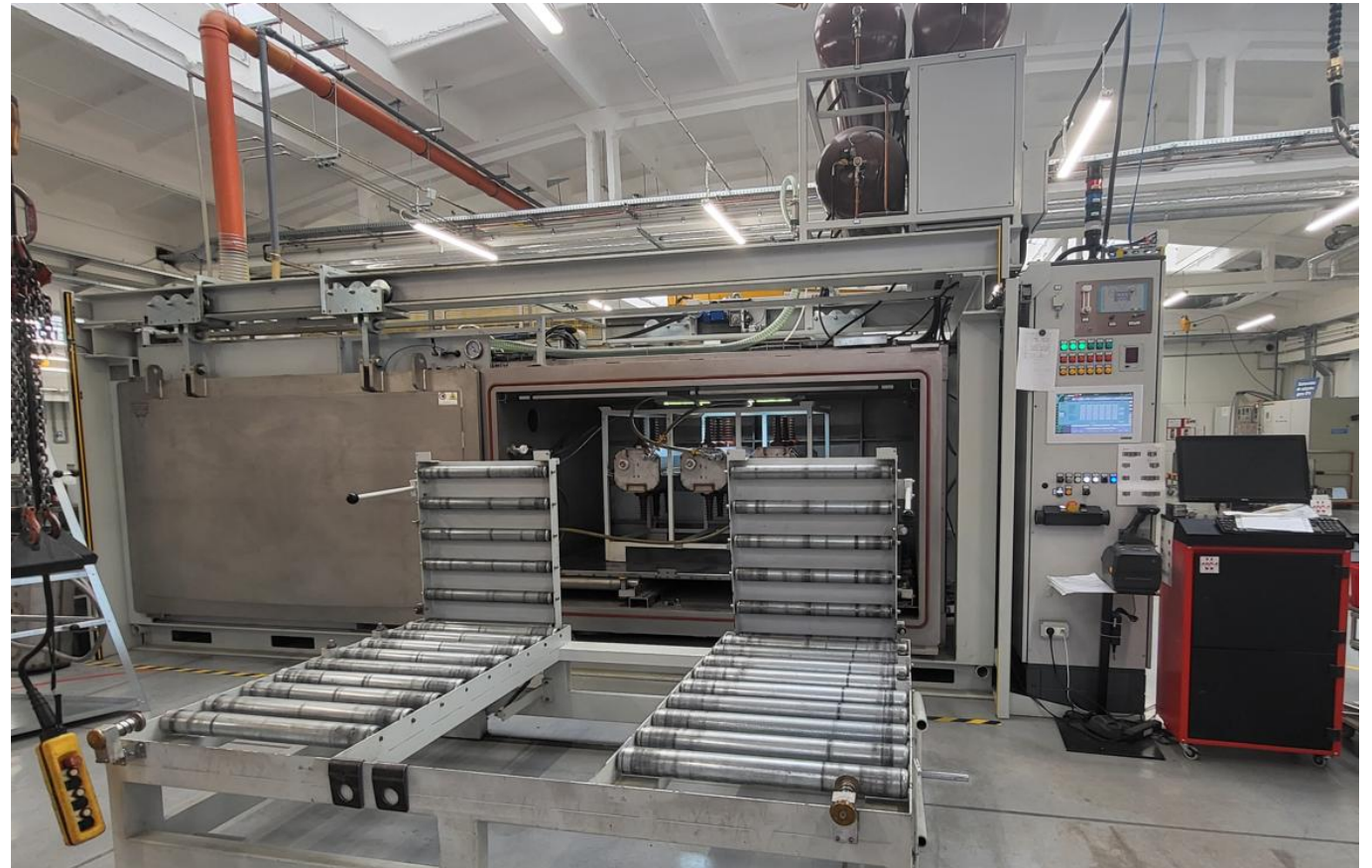
ZPUE - Test szczelności metodą helową
