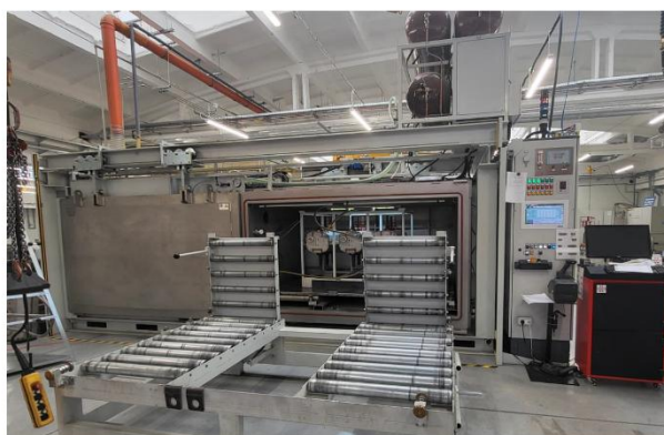
ZPUE - Test szczelności metodą helową
