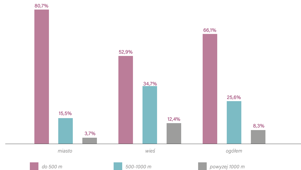
Rys. 9. Struktura długości obwodów linii niskiego napięcia [1]
